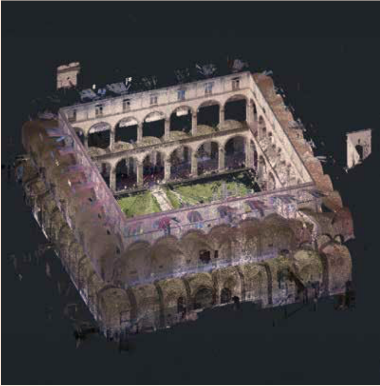
Napoli, Dipartimento di Studi Umanistici, San Pietro Martire. Visione assometrica della nuvola di punti da scansione da laser-scanner del Chiostro
